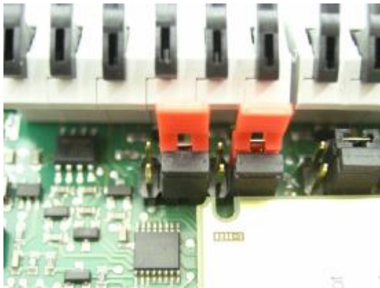
Pour 2 sondes de température
