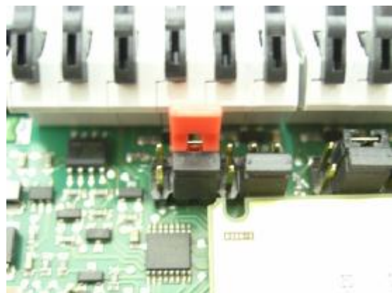
Pour la temp. sur 1 et pour l'hum. du sol sur 2
