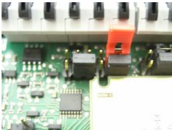
Pour l'hum. du sol sur 1 et la temp. sur 2
