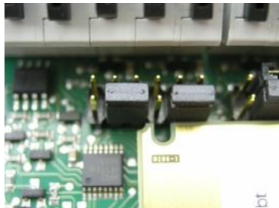
Pour 2 sondes de tension ou d'hum. du sol
