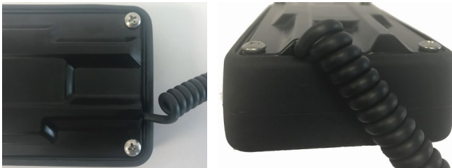
Abbildung 2. Durch den Schlitz geführtes Sensorkabel
