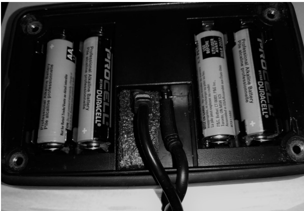
Fig. 1 : Câble raccordé. Dispositif de rétention en mousse installé.
