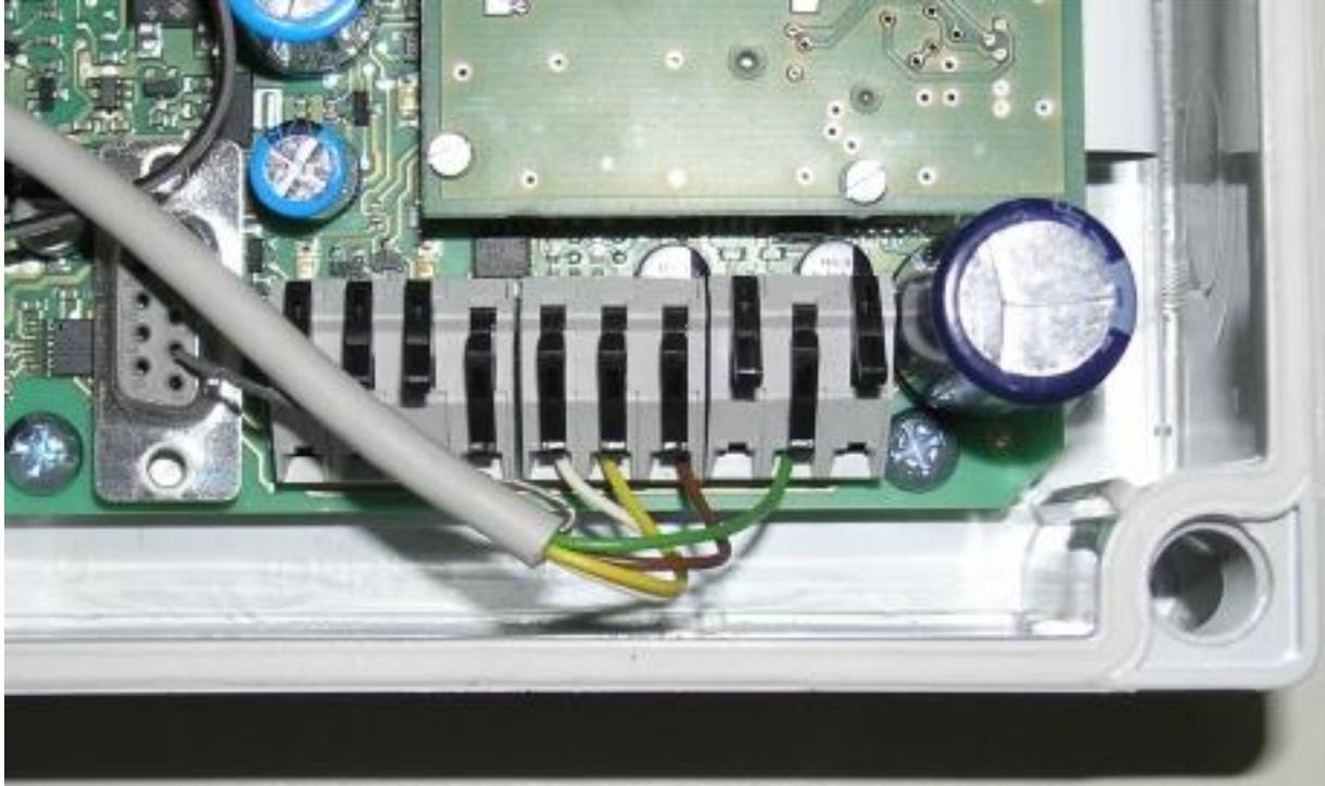
Die Drähte des Kombi-Sensors für Temperatur & rel. Luftfeuchte
