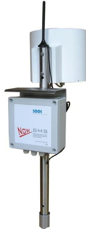
Es wird empfohlen, den Regenmesser nach dem endgültigen Aufstellen im Feld auf Null zurückzusetzen, da der Kipplöffel während des Aufstellens hin- und herkippen kann, und so bereits zu zählen beginnt.
