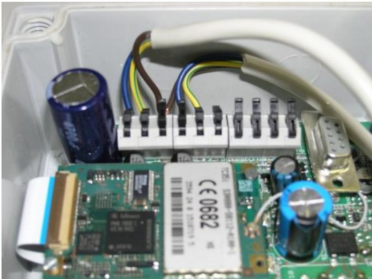
Die Drähte des Tensiometers IR-E
