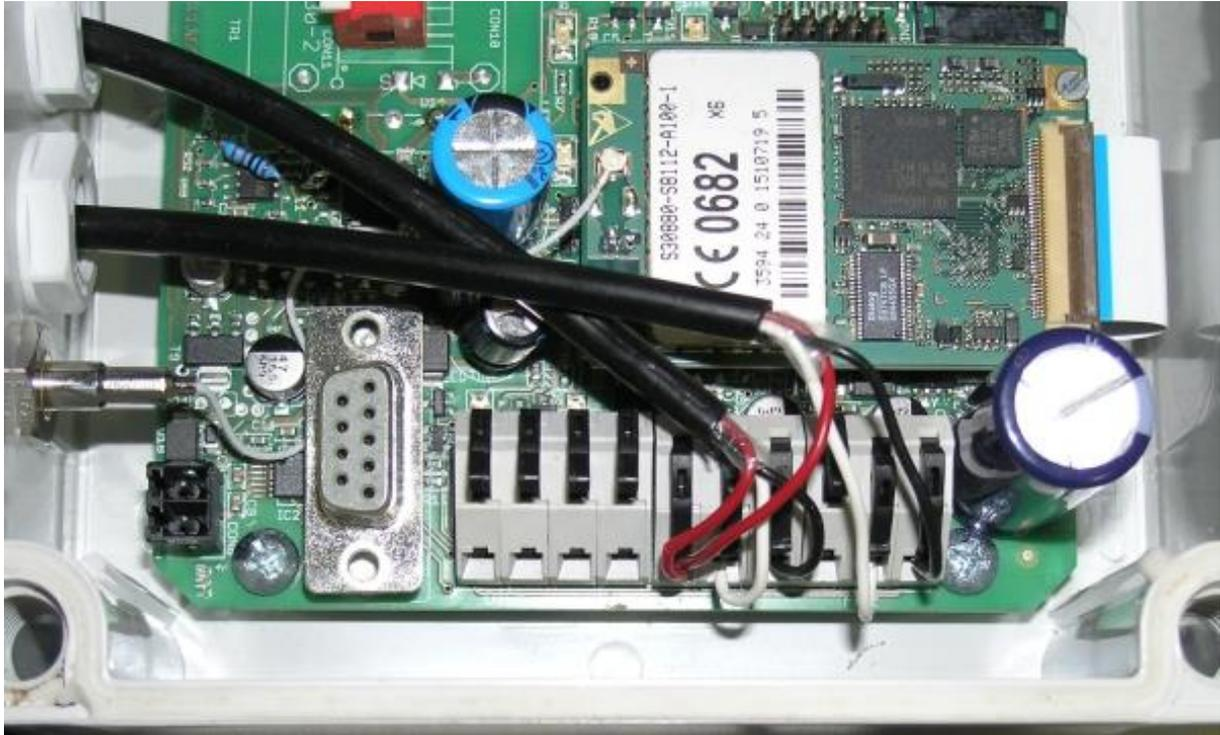
Die Drähte des Watermark Sensors, mit Voltadapter WM-S-VA
