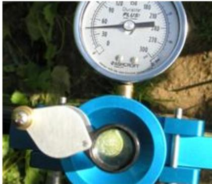
10. Nach jedem Kolbenhub Prüfen, ob Wasser an der Schnittstelle austritt
